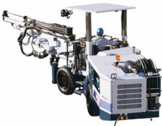
Robusto equipo de perforación subterránea de alto rendimiento. Es controlado hidráulicamente, posee un brazo telescópico con paralelismo automático e incorpora un sistema de protección anti-atascos. Además, incluye sistema de barrido semi-húmedo dependiente de redes.
