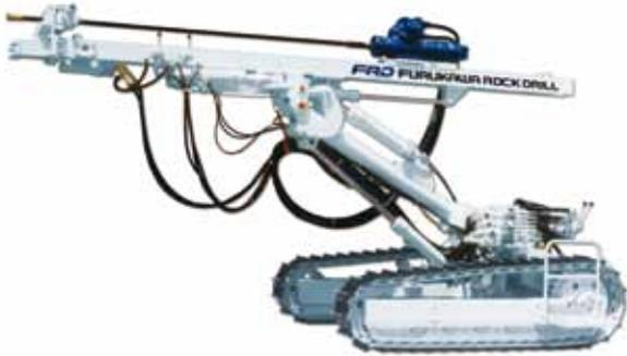
Robusto tren de rodado de bajo mantenimiento y larga vida útil, incluye dispositivo en brazo, para realizar barrenos horizontales.
