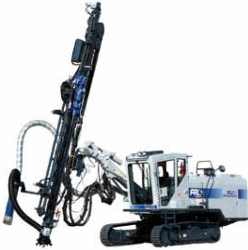
Es el modelo Top Hammer más potente, pudiendo ser utilizado para aplicaciones en pre-corte, producción, extracción selectiva, despresurización de roca y explotación de canteras, hasta una profundidad de 26 m. Existe también la opción de una versión para su uso con single pass con barras de 6 m de longitud.
